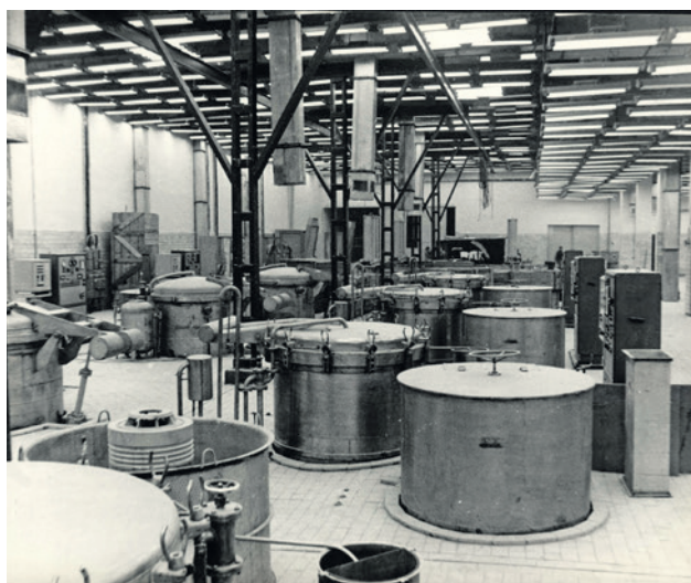
1976 r. Fragment hali farbiarni - na pierwszym planie aparaty farbiarskie. Zakład jest już gotowy do rozruchu. Z ARCHIWUM NOVITY
